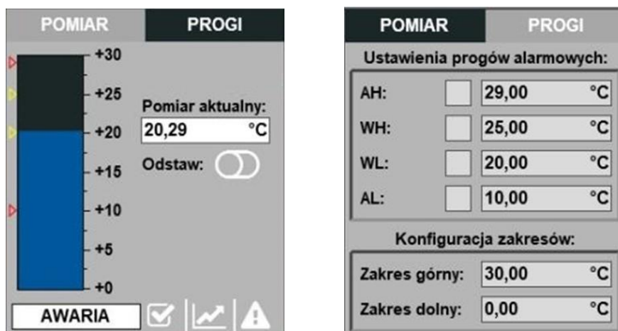
Zdjęcie nr 8 powyżej przedstawia standard wizualizacji stacyjki pomiaru technologicznego.
